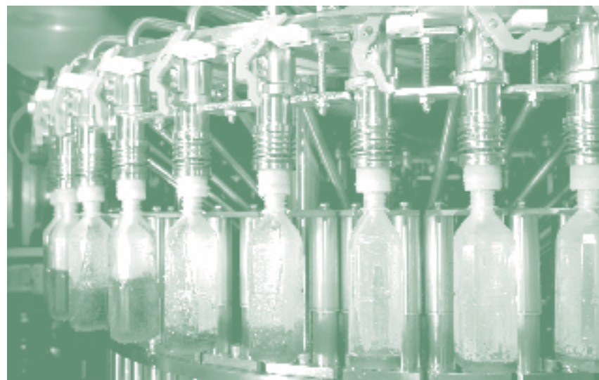
鴻福堂的涼茶入樽系統可在無菌狀態下，將涼茶灌注入膠樽之中，不用添加任何防腐劑，飲品的保質期仍可達一年，使鴻福堂可迅速發展其批發市場。
